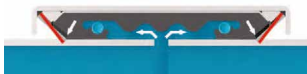
Effet progressif d'ancrage
